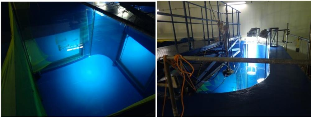
写真2 大型水槽（300トン）による音響基礎実験
