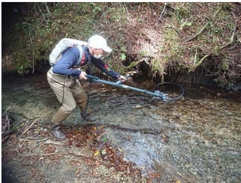
写真1 持ち運び式の PIT タグアンテナを用いた魚類の居場所調査
