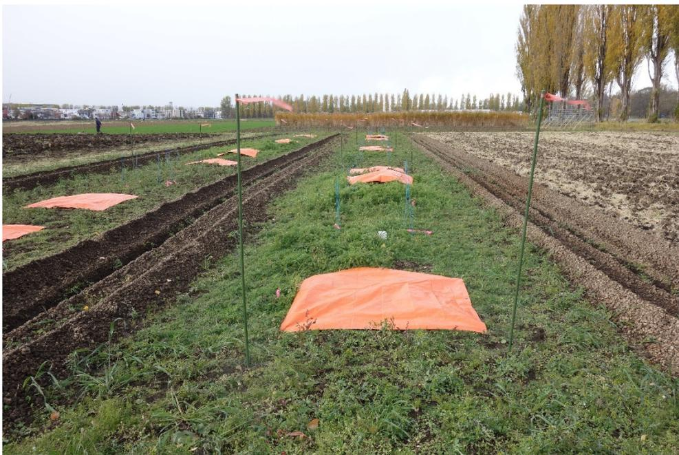
写真2 圃場試験の準備状況 オレンジシートは除雪区です。土壌凍結を促がすため降雪後にシート上を除雪します。
