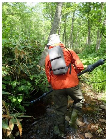
雨竜研究林における学生実習。専用機器を用いてICタグを装着した魚類の位置を調査しています。
