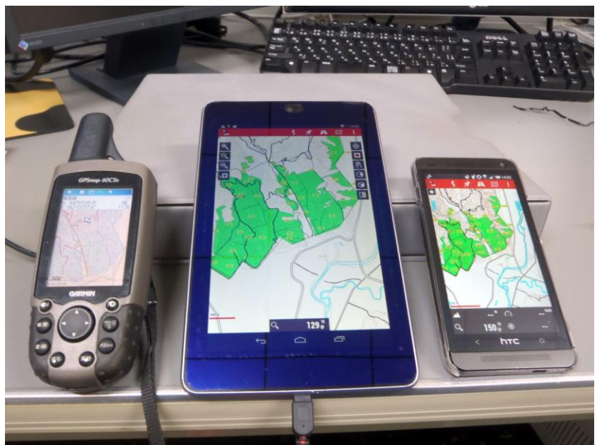
GIS 上で編集された各種情報を GPS 受信機と携帯端末に表示している様子
