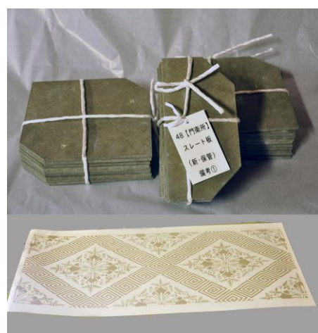
今回の工事で製作された 天井紙とスレート板
